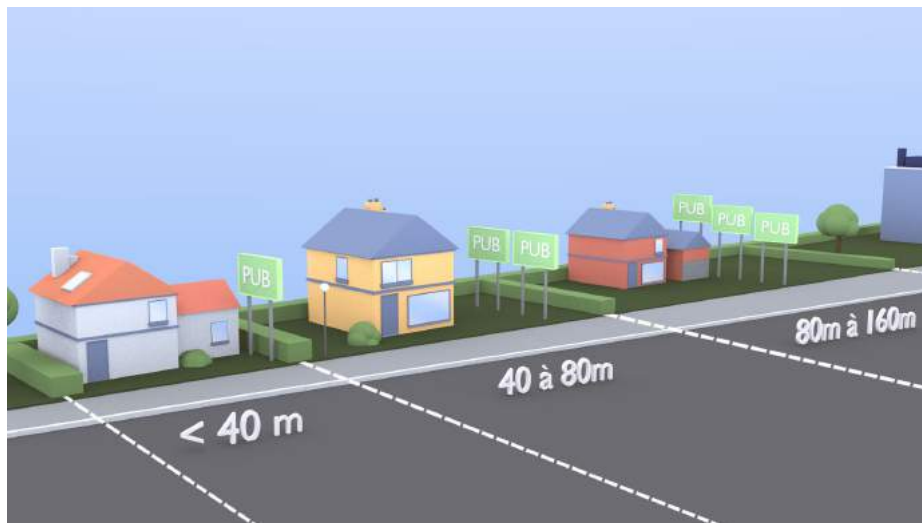
Un dispositif dans l'unité foncière dont la longueur bordant la voie est inférieure ou égale à 40 m. Deux dispositifs entre 40 m et 80 m. Un dispositif supplémentaire par tranche entamée de 80 m.
